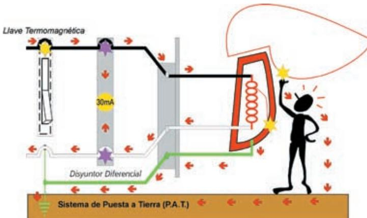
El circuito de Puesta a Tierra es una medida de Seguridad que provee un camino de baja resistencia para que circule una posible corriente diferencial de fuga en presencia de Contactos Directos o Indirectos. (Norma IRAM 2281 – Parte III)
