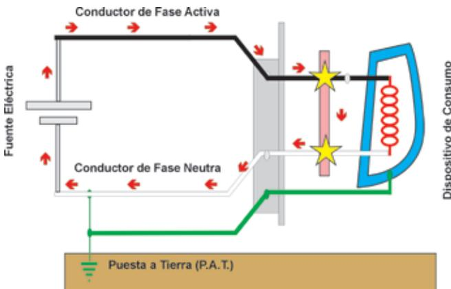
Ocurre cuando las personas entran en contacto con partes metálicas (masas) puestas accidentalmente bajo tensión a raíz de una falla de aislamiento.
