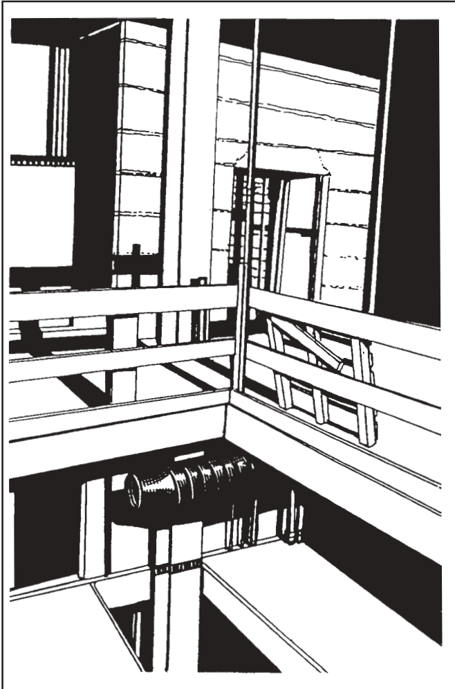
Figura 5. Protección de rebordes: Las barandillas y tabloncillos protectores de plomo colocados en torno de las aberturas del piso y de las plataformas de trabajo previenen la caída de los trabajadores.
