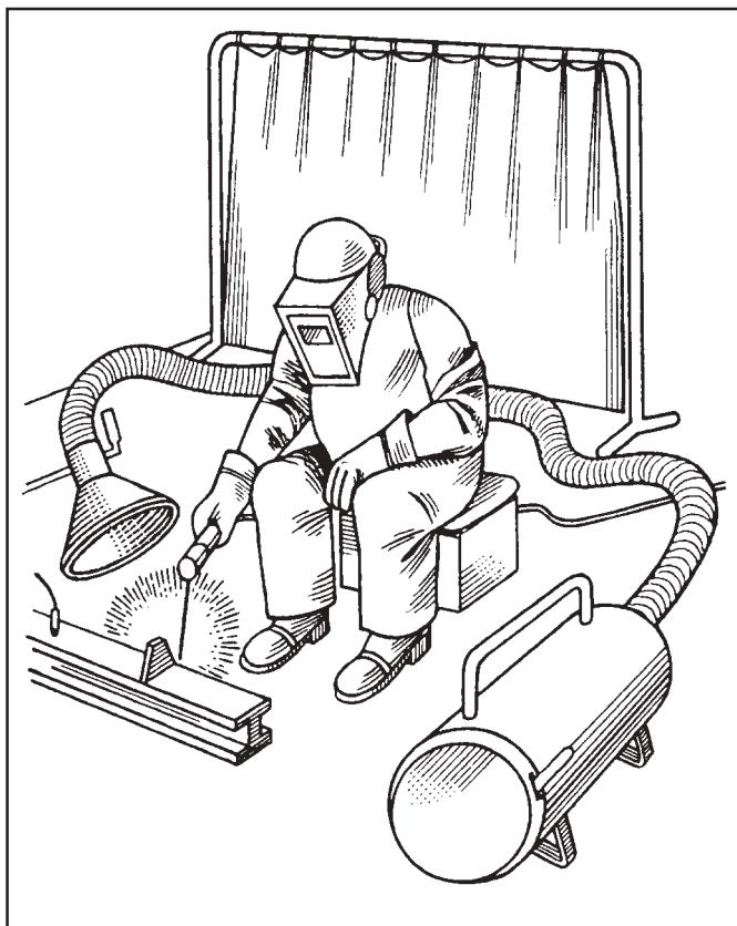
Figura 45. Soldadura de arco eléctrico: pleza de trabajo con conexión a tierra, soldador con equipo de protección personal, sitio de trabajo aislado con mamparas.
