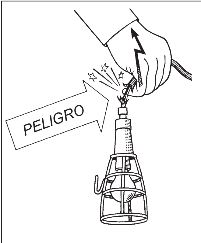
Figura 44. Instalaciones eléctricas: preste especial atención a las condiciones del equipo eléctrico provisorio o portátil y al estado de los cables.
